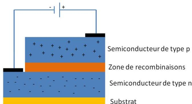
Lorsqu'un électron passe de la zone dopée n à la zone dopée p, il y a émission d'un photon au niveau de la zone de recombinaisons.
